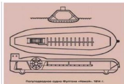
Полуподводное судно Фултона «Немой», 1814 г.
